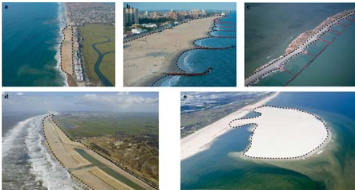
Figura N°16. Tipos de disposición de arenas: a) en un tramo de costa, b) y c) combinando con espigones, d) en tramos extensos y e) a gran escala, como en el Zandmotor
